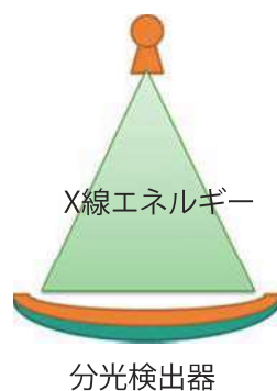
一つの管球で一回の撮影で検出器にてエネルギーを変える方法
