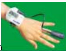
図2 簡易型の検査器(パルスオキシメータ)
